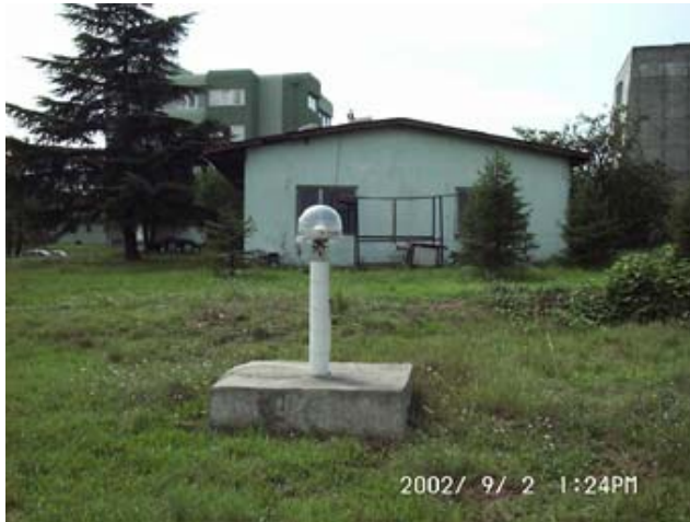
Şekil 3. Tubitak sabit GPS istasyon noktası TUBI. Figure 3. Tubitak fixed GPS station point TUBI.
